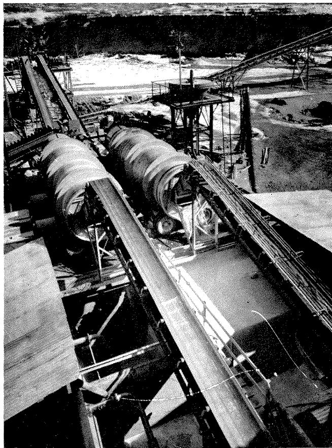
CI-CONTRE : Le poste de débouillage avec les tubes NEYRPIC ROLOFLUX , les bassins de décantation et au second plan un hydroséparateur et une vis WEMCO pour l'essorage des sables.
