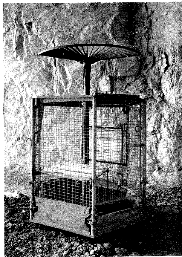
CI-DESSUS : La nacelle servant à la perforation de l'avant-puits.
